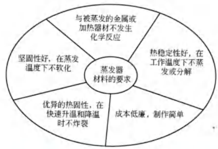
图2-13真空蒸馏提纯法制备高纯金属时对蒸发器材料的要求
